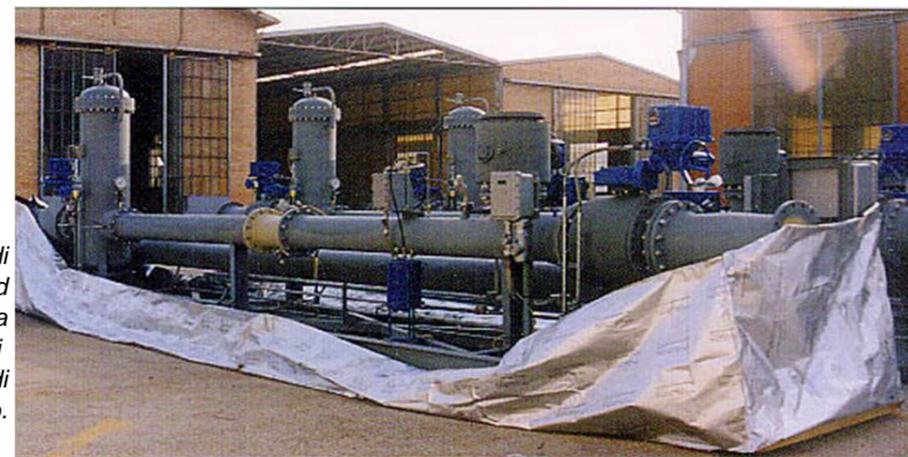
Le cuffie in accoppiato polibARRIERA a norme MIL, con Sali disidratanti, confezionate a misura e termosaldate con aspirazione di parte dell'aria, mantengono al proprio interno una umidità relativa costante.
